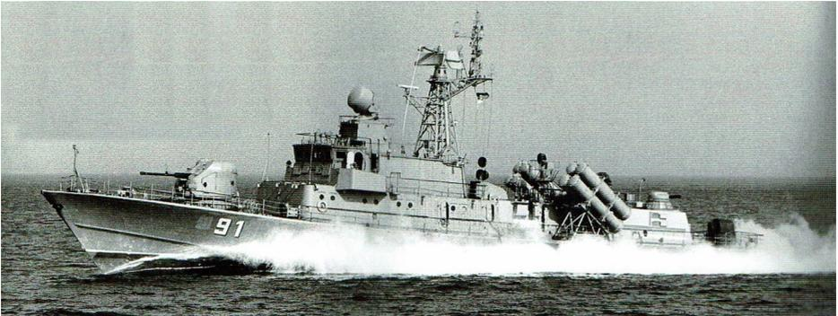
ZUFÜHRUNG: Kleines Raketenschiff der Balcom-Klasse bei der Erprobung; ohne Raketen dienten diese als Patrouillenboote
